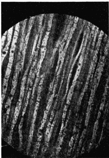
Obr. 10. Tangenciální řez okrajovou čarou nepravého jádra. Všechny cévy ucpany četnými tyly. Mikrofoto 35 ×. (Orig.) (Vlevo.)
