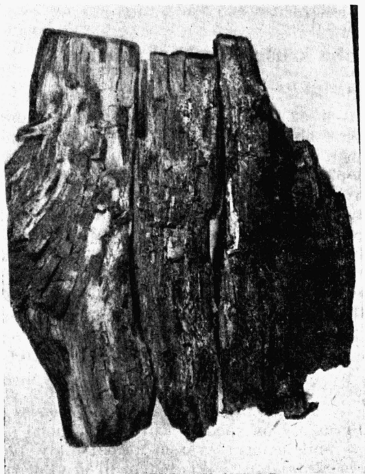
Pokročilá hniloba smrkového dřeva způsobená outkovkou různotvarou Trametes heteromorpha (F r.) B r e s. — Foto Maštalíf.
